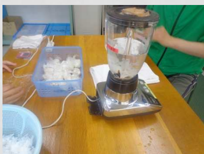
【作業①】牛乳パックから取り出したパルプをミキサーにかける場所
